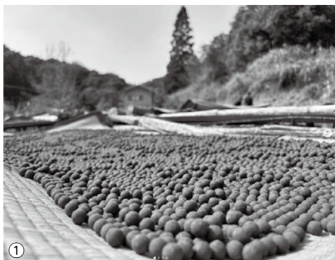
①天日乾燥を繰り返しながら「星」と呼ばれる火薬を作る
