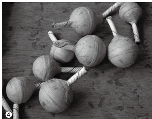
④ 打ち上げ花火に仕込む「小割り」
