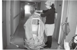
独自開発の加熱機で寝具の湿気を飛ばし、乾燥し、ほぐれた繊維から超振動機器によりダスト、ダニを吸引
