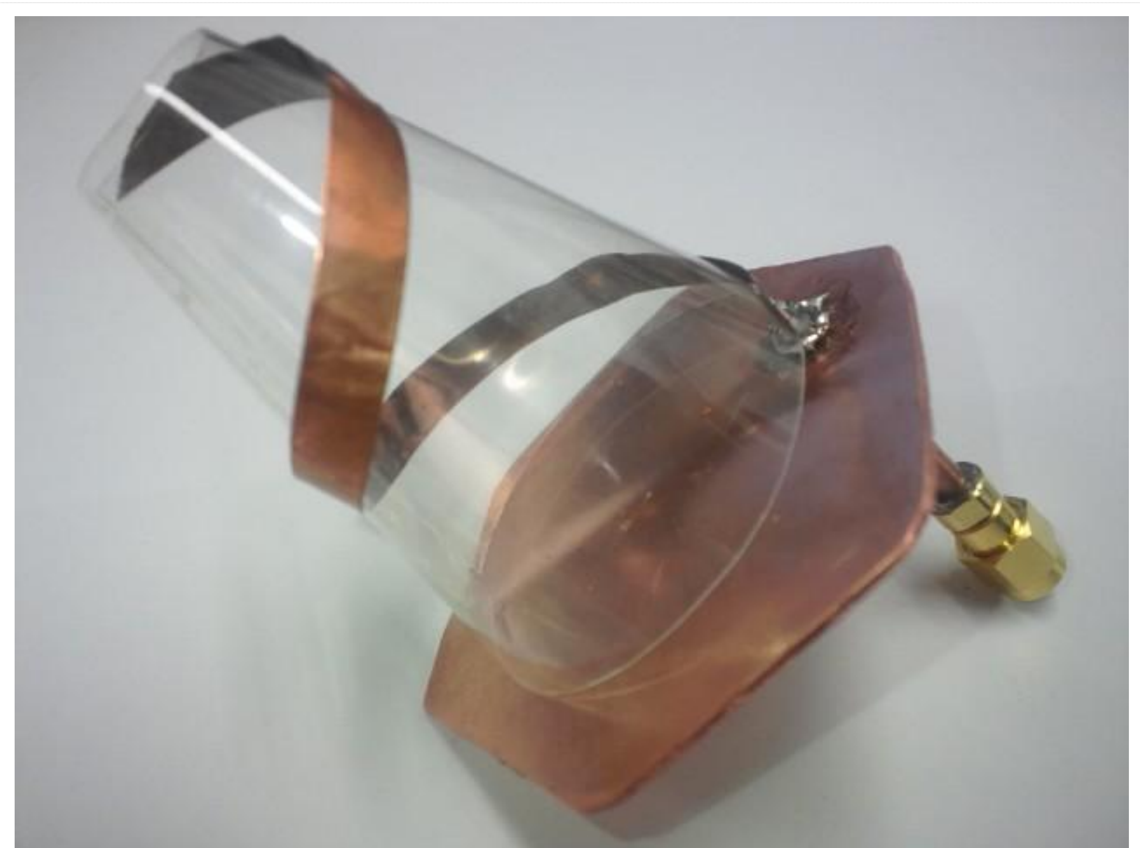
新開発のヘリカルコーンアンテナ (広帯域円偏波電磁波計測のセンサとして利用)
